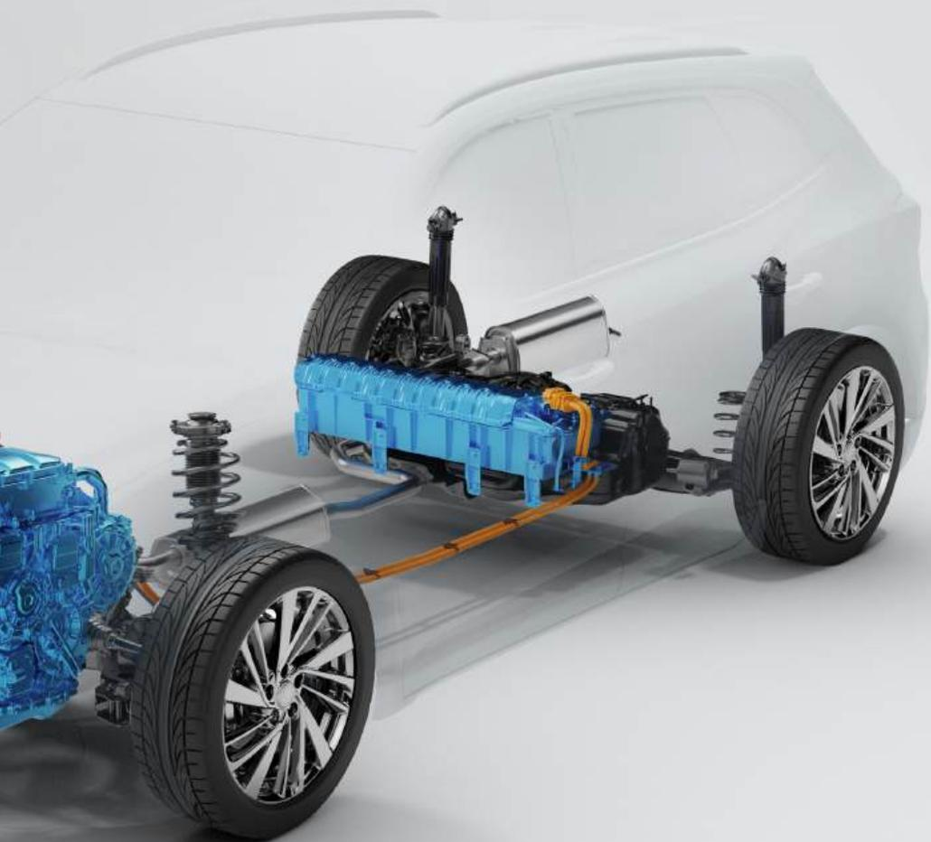
**Parallel-Hybrid:** Die beiden Motoren, Elektro- und Verbrennungsmotor, arbeiten zusammen, um das Fahrzeug anzutreiben, was ideal für dynamisches Fahren und optimale Leistung ist.
