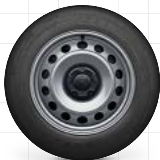
15"- und 16"-Stahlräder mit Radnabenabdeckung, 6½ J x 15, Reifen 195/65 R 15 und 6½ J x 16, Reifen 205/60 R 16
